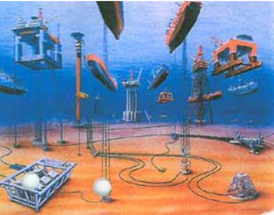
Et utvalg av produksjonsutstyr som er i bruk på et petroleumfelt. Med marine operasjoner menes slike operasjoner som kreves for å bringe utstyret på plass samt gjøre det driftsklart. Fra [10.12]
