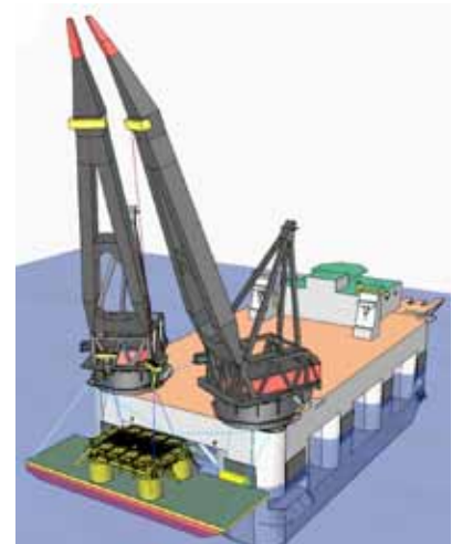
Kranfartøyet "Thialf" er et av verdens største, med løftekapasitet 2x7000 tonn.
